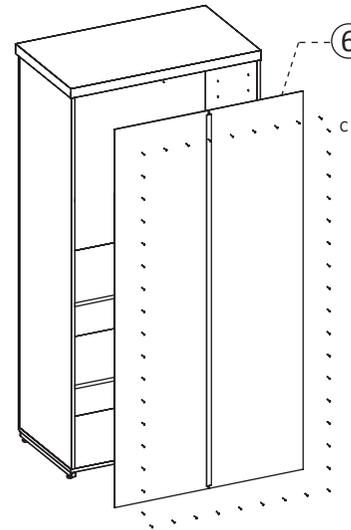
POSICIONE O FUNDO DE 3mm (6) NO ARMARIO E PREGUE COM O AUXÍLIO DE UM MARTELO
