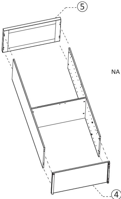
NA SEQUENCIA FIXAR A BASE (4) COM O RODAPÉ PRÉ-MONTADO, TAMPO ENGROSSADO (5)
