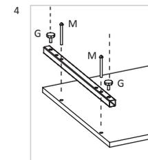
ROSQUEAR NIVELADORES NO RODAPÉ METALICO E POSICIONAR PARAFUSOS ESTRUTURAIS NA BASE
